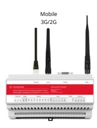
Die Mobilfunkantenne muss vor dem Einschalten des Geräts an den Anschluss zwischen der Ethernet-Buchse und dem seriellen DB9-Stecker angeschlossen werden, um Schäden zu vermeiden.
